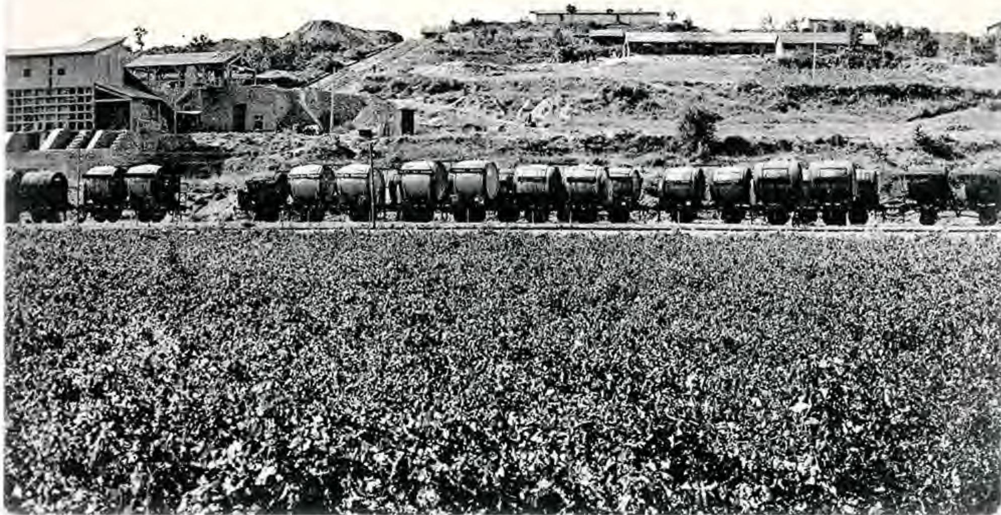
Voies de service de la gare, parallèles à la voie directe, en 1922. Des wagons bi-foudres stationnent sur des voies de remisage. A la fin des années 1930, la Société des Wagons Biterrois avait installé dans cette annexe de la gare, un centre de vérification et de réparation des wagons foudres.
